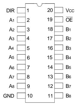
SOIC/ SSOP/ QSOP/ TSSOP TOP VIEW
